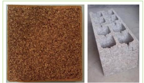
**Figura 3** Incorporação de granulado de carolo de espiga de milho na produção de placas e blocos de betão leve [6].
