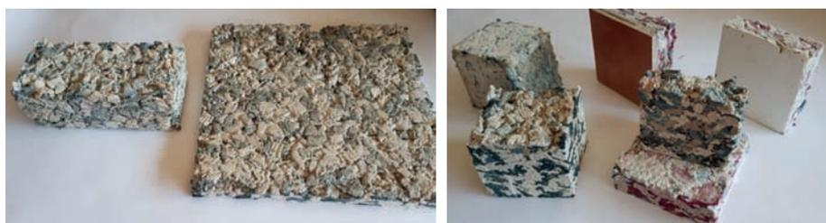
Figura 2 Incorporação de resíduos têxteis em elementos de construção leve.
