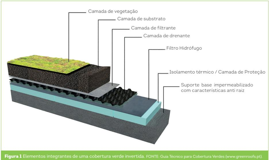
**Figura 1** Elementos integrantes de uma cobertura verde invertida. FONTE: Guia Técnico para Cobertura Verdes ([www.greenroofs.pt](http://www.greenroofs.pt)).
