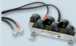
Grças às suas características únicas, dimensão compacta e possibilidade de montagem em calha DIN ou em painel, a instalação é extremamente simplificada. O transformador de intensidade TCD068X proporciona uma solução múltipla, permitindo a medição de cada uma das cargas diretamente à saída dos disjuntores dos respetivos circuitos.
