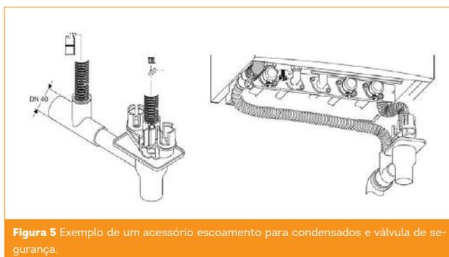
Figura 5 Exemplo de um acessório escoamento para condensados e válvula de segurança.
