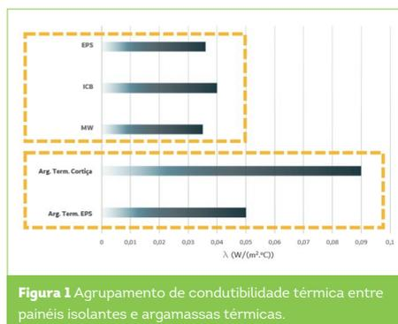
**Figura 1** Agrupamento de condutibilidade térmica entre painéis isolantes e argamassas térmicas.
