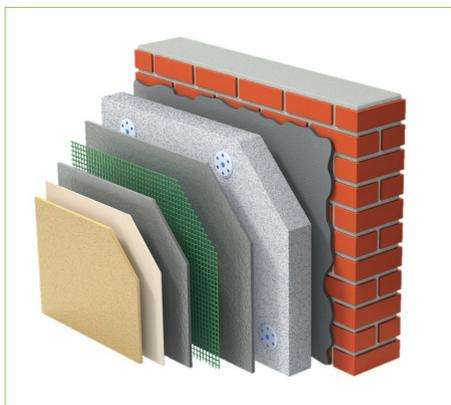
vidro e acabamento final (revestimento espesso colorido).
