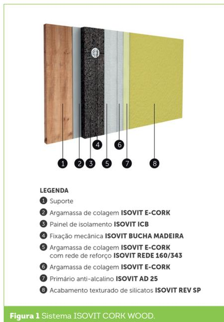
Figura 1 Sistema ISOVIT CORK WOOD.
