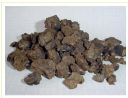
**Figura 1** Regranulado de Cortiça Expandida - R-ICB.
