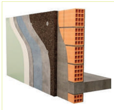
Figura 1 - Ilustração de um sistema convencional de ETICS
