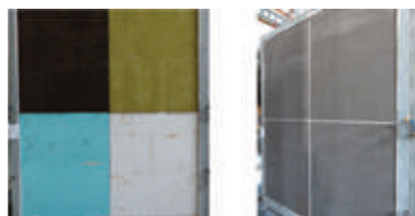
Figura 3 - Construção do proveito (2,2 m x 2,5 m) destinado ao ensaio de sucção dinâmica
