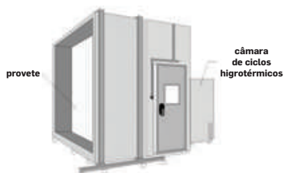
Figura 7 - Representação esquemática da câmara de ciclos higratérmicos
